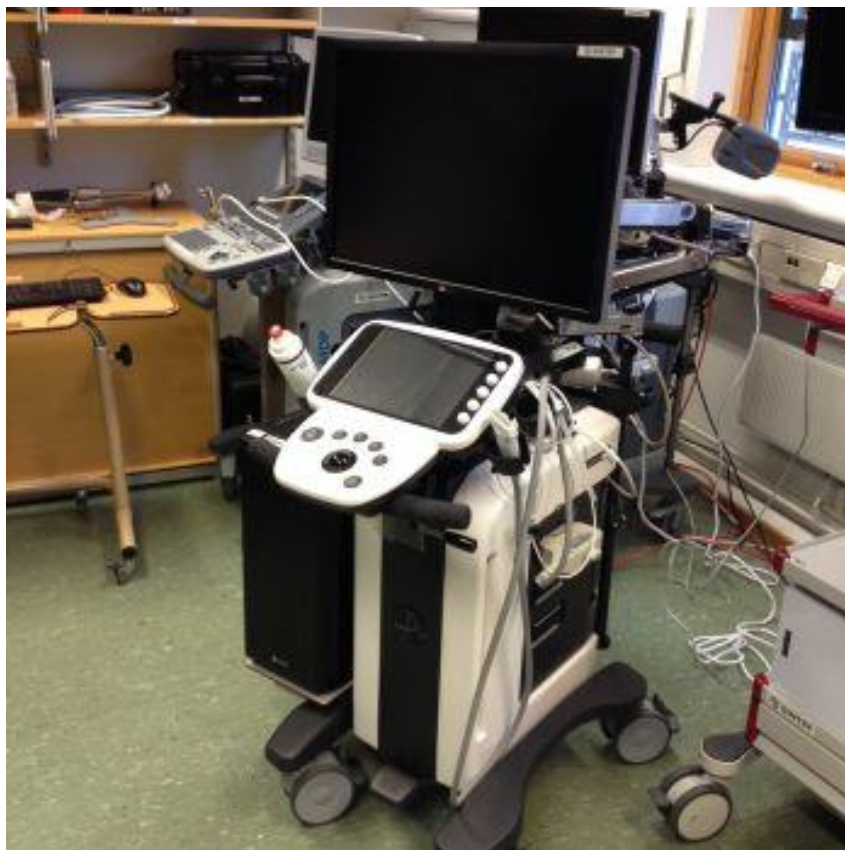
Asistent lokálnej anestézie (RAAs) pozostáva z prvotriedneho ultrazvukového systému, systému pre sledovanie sondy, počítača a veľkého displeja pre zobrazenie rozšírenej reality
