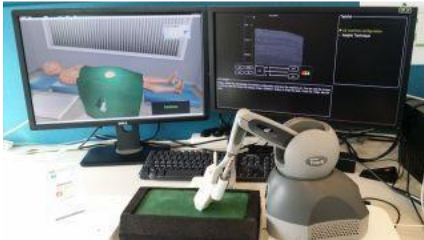
Het Regionale Anesthesie Simulator (RASim) prototype toont een haptisch apparaat met de naald die op een schuim rust. Er zijn twee schermen vereist voor de situs (links) en het cursusmateriaal (rechts).
